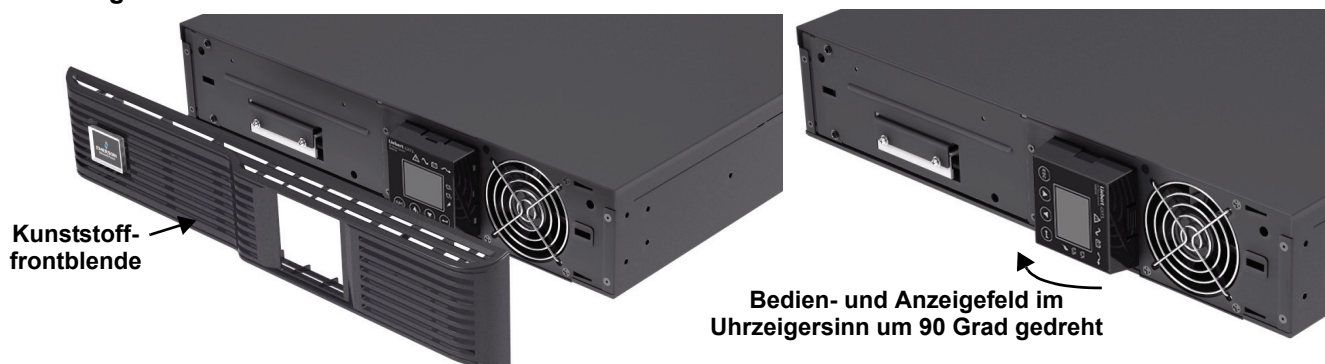
Abbildung 8 Entfernen der Kunststofffrontblende
