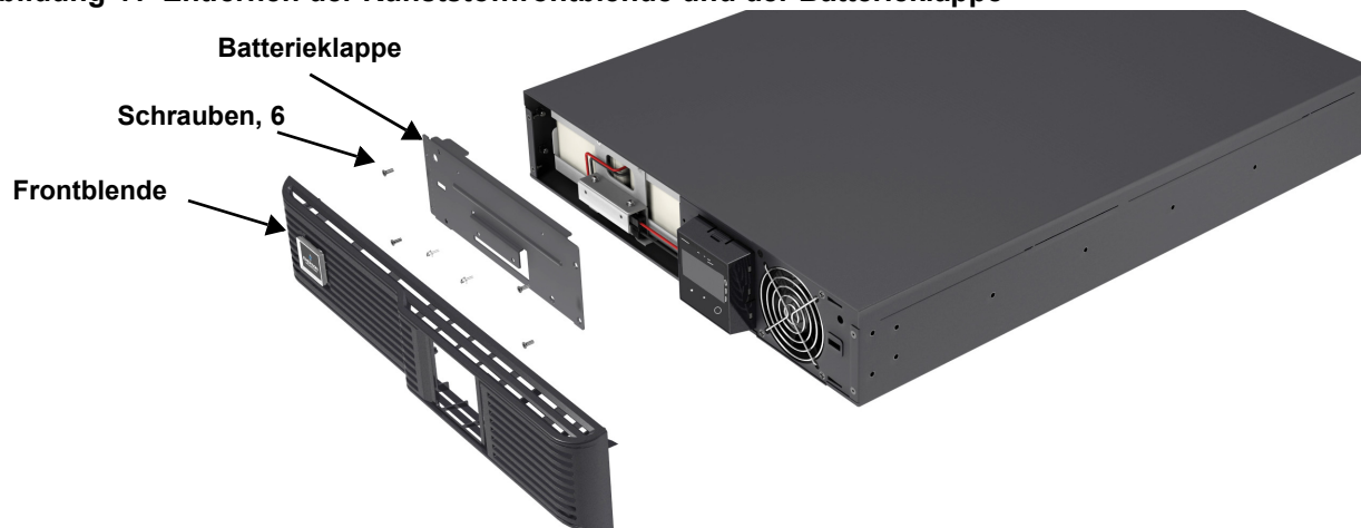
Abbildung 41 Entfernen der Kunststofffrontblende und der Batterieklappe
