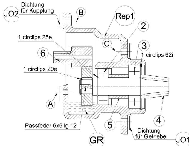
Schrauben und Muttern sind bei der Montage mit LOCTITE Typ 243 zu sichern
