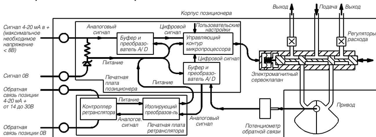
РИСУНОК 5. ПРИНЦИПИАЛЬНАЯ ФУНКЦИОНАЛЬНАЯ СХЕМА ЦИФРОВОГО ПОЗИЦИОНЕРА EL
