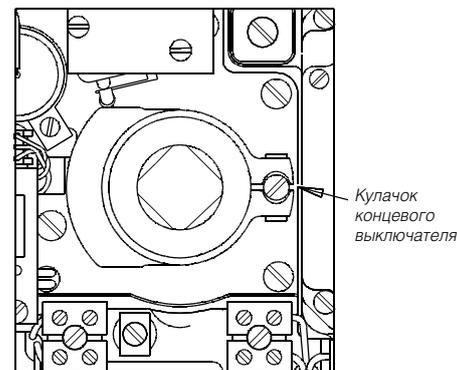
РИСУНОК 6б. МЕТАЛЛИЧЕСКАЯ МУФТА, УПОР ЦИФРОВОГО ПОЗИЦИОНЕРА EL. ОТКРЫТЫЙ КОРПУС, ВИД С ВЕРХУ
