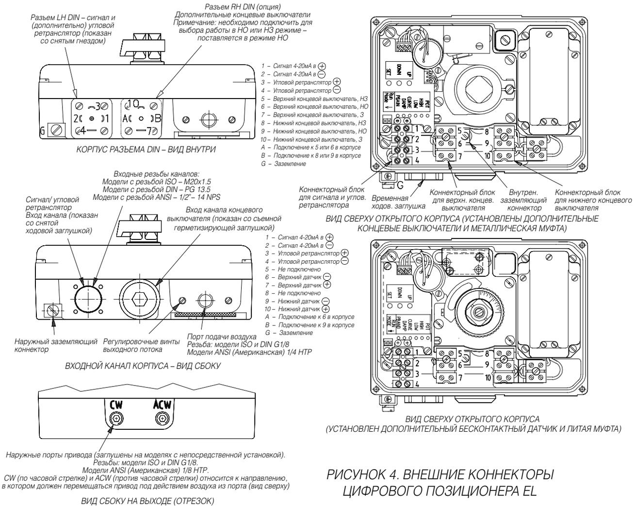
**ПРИМЕЧАНИЕ:** Наружные электрические разъемы также обозначены на ярлыке под крышкой. После снятия крышки для подключения/регулировки не убирайте смазку с крышки уплотнения вала.
