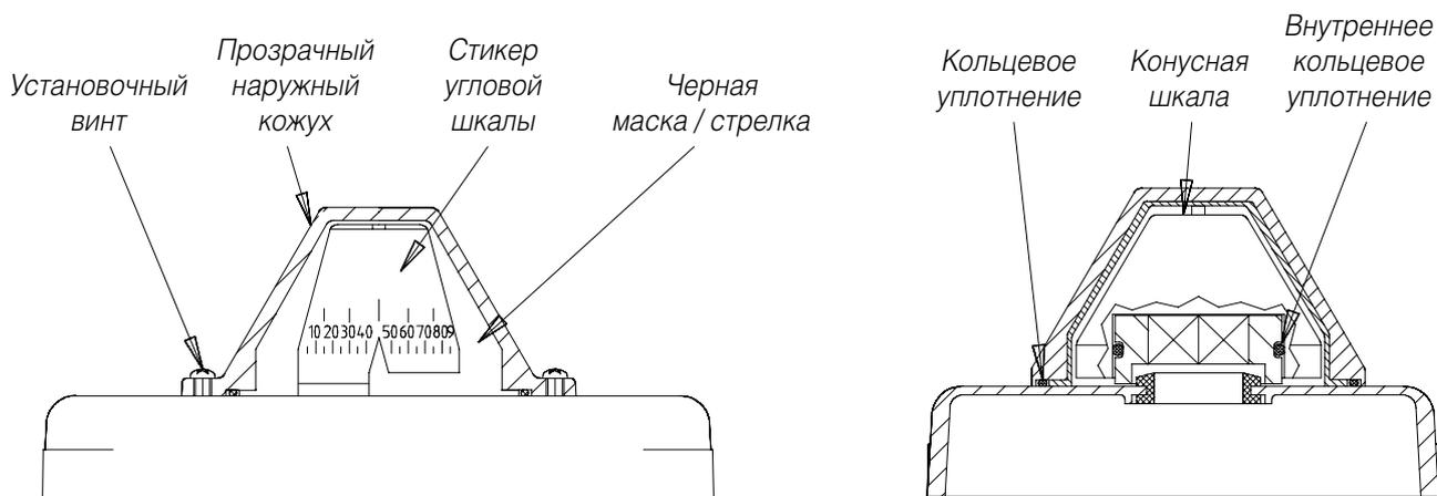
Рисунок 9. Крышка EL – Регулировка монитора Clear Cone
