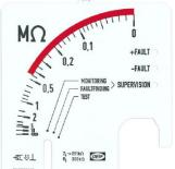
Fig. 1, 1000...0  $k\Omega$  scale
